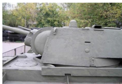
Рис.8 Сварная башня танка КВ-1
