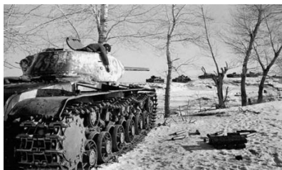
Рис.1 Литая башня КВ-1
