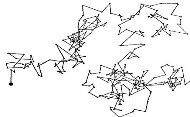
Броуновское движение частички гуммигута в воде. Мелкими точками отмечены положения частички через каждые 30 сек. (По Перрену.)
